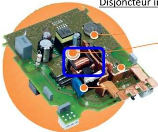
**Organe de coupure.** Linky intègre un disjoncteur interne constitué par un relais électromécanique de forte puissance (spécifié à 100 ampères).
