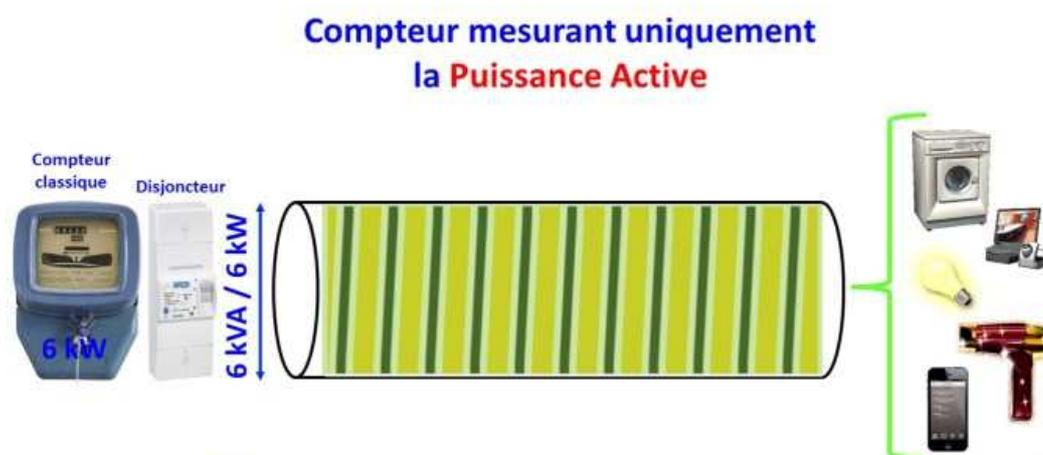
**kVA = kW → Le disjoncteur supporte jusqu'à 6 kW (30 A)**
